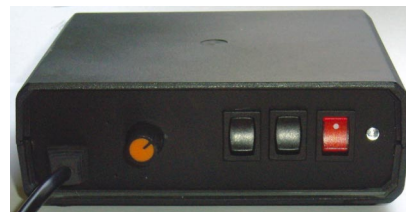
Obr. 7. Pohled na zadní panel a ovládací prvky. Zleva: potenciometr na řízení rychlosti blikání, přepínač chod/stop, přepínač režimů, hlavní vypínač a kontrolka chodu
